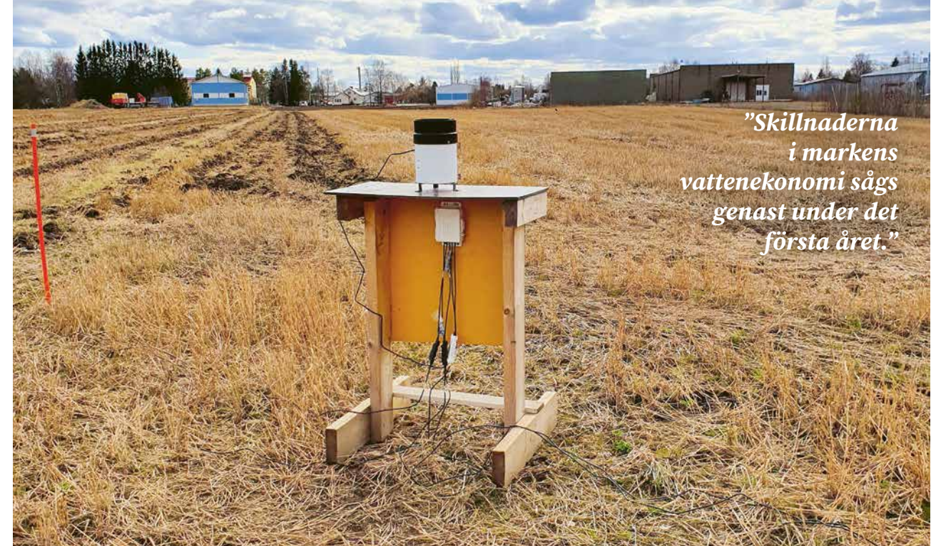
I BILDEN provpunkten med väderleksstationen och datalogger. Till vänster alvluckrade och till höger icke-alvluckrade området när försöket startades.
